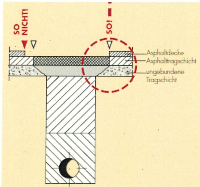
Die Asphaltschichten sind nach dem Einbau der Tragschichten ohne Bindemittel um das Maß der Auflockerung der Randzonen der Tragschichten ohne Bindemittel zurückzunehmen.
